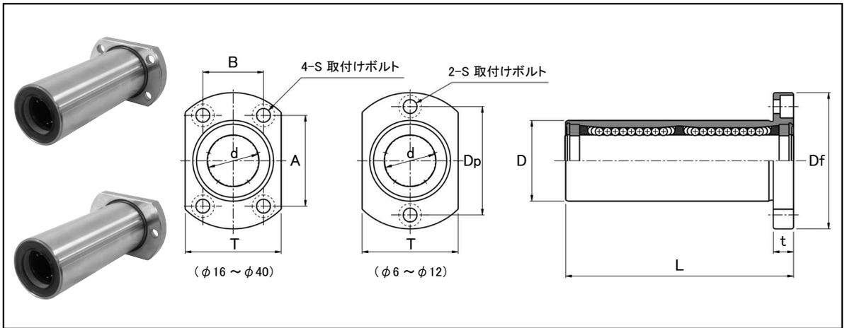
表：LFDT-MF, MLFDT-MF, ULFDT-MF, UMLFDT-MFシリーズ寸法表
