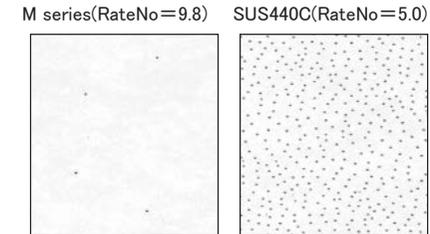
Mシリーズは塩水噴霧試験法により、ステンレス鋼（SUS440C, QD51）よりはるかに耐食性があり、防錆効果が高い事は証明されておりますが、耐酸性についてはどうか？の問い合わせが多く、その試験を行いましたので試験結果を下記の通り報告いたします。
