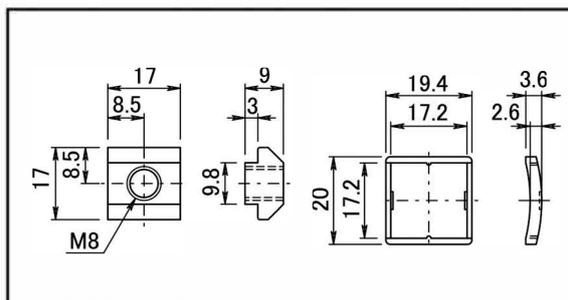
M8ナットをTスロットに挿入しアングルブラケットで取付することが出来ます。
